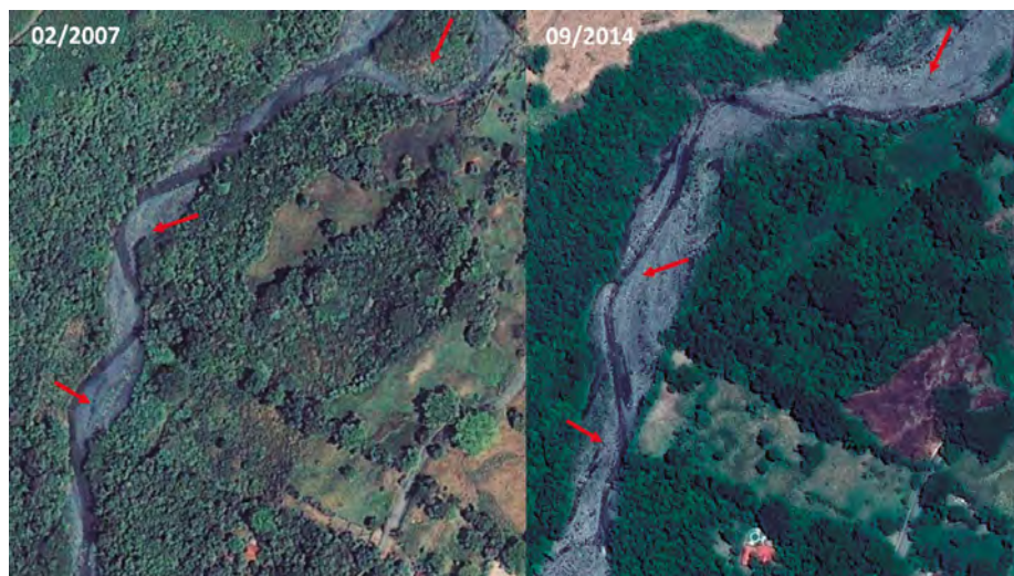
Figura 22. Depósitos laterales y migración del canal quebrada La Negra, Útica, Cundinamarca
