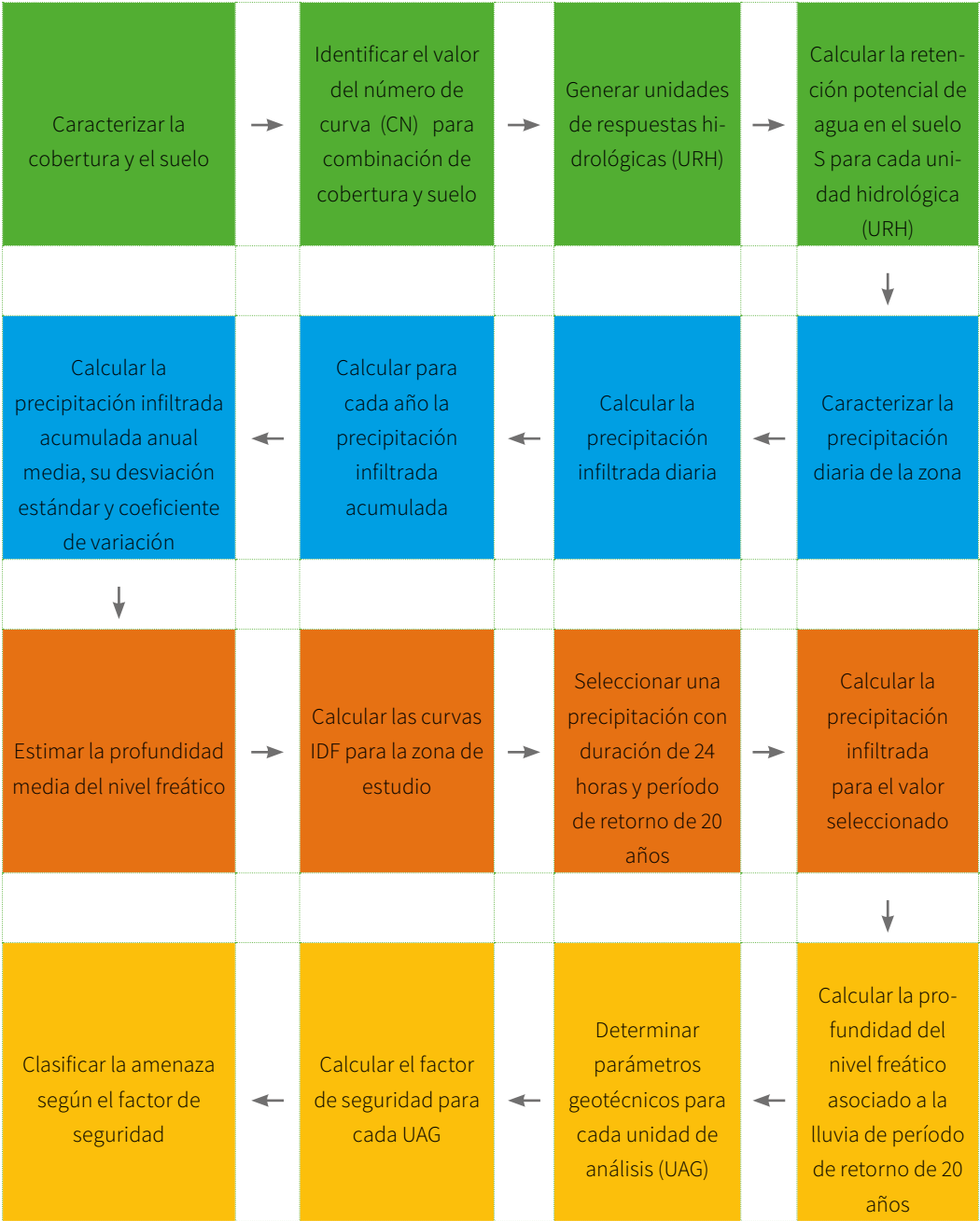
Figura 43. Metodología para determinación de amenaza de deslizamientos por aumento del nivel freático
