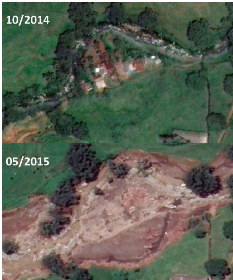
Figura 18. Depósitos y migración del canal quebrada La Liboriana, Salgar, Antioquia
