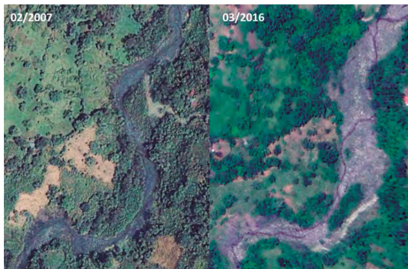
Figura 21. Ensanchamiento del canal quebrada La Negra, Útica, Cundinamarca
