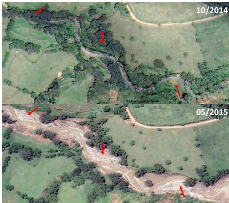
Figura 19. Depósitos en forma de barras laterales en las curvas y ensanchamiento del canal en quebrada La Liboriana, Salgar, Antioquia
