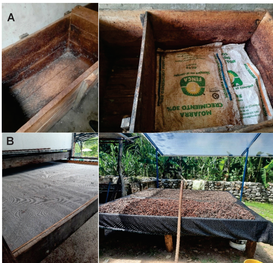
Figura 7. Procesamiento del cacao. A. Cajones fermentadores de madera. B. Secadores de cacao al sol
