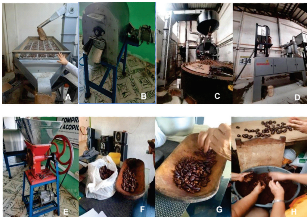
Figura 9. Proceso de tostado del cacao. A. Separador de impurezas. B y C. Tostadoras de cacao. D. Máquina descascarilladora. E. Molino. F y G. Descascarillado manual. H. Elaboración de chocolate manual y chocolate en bola artesanal
