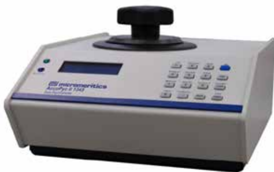
Figura 54. AccuPyc II sistema de picnometría por desplazamiento de gases
