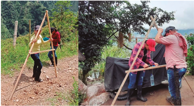
Figura 3. Construcción de agronivel
