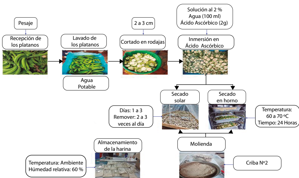
Figura 1. Obtención de harina proveniente del racimo de plátano
