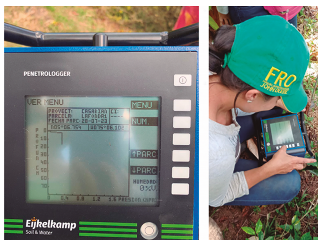
Figura 4. Equipo Penetrómetro (Eijkelkamp soil & Water)
