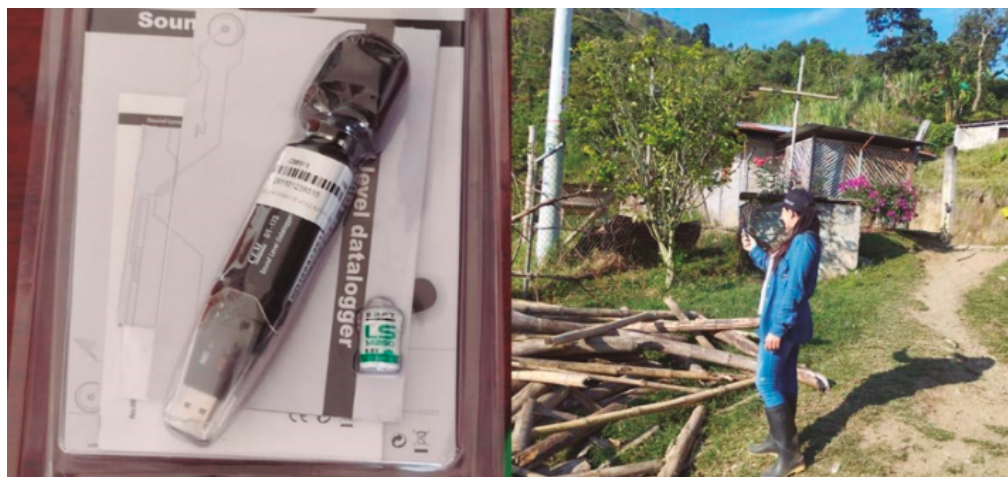
Figura 16. Medición de ruido con el sonómetro en campo
